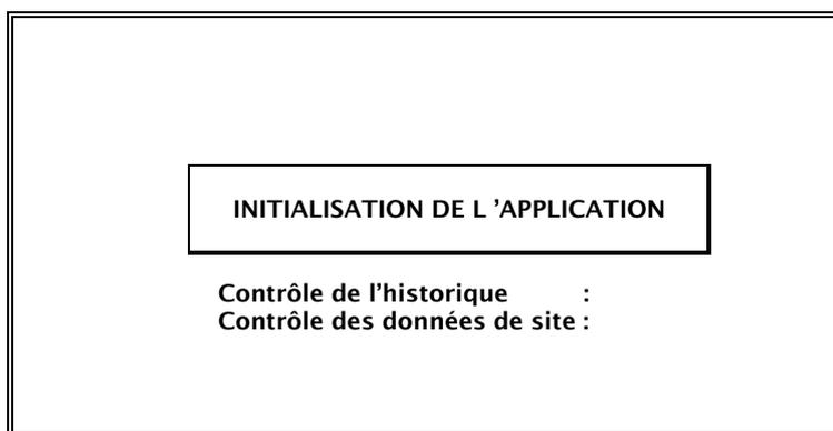
Le processus d'initialisation achevé, l'ADEX conduit aussitôt une phase de mise à jours des registres au sein desquels il mémorise l'état des différentes composantes du système (UGCIS, Zones, DAS) en émettant un ordre de « Réactualisation » à destination de la *Partie Centrale*. Après traitement de la requête, une série de trames est ainsi réceptionnée, permettant à l'ADEX d'actualiser l'ensemble des informations visuelles dont il est doté :
