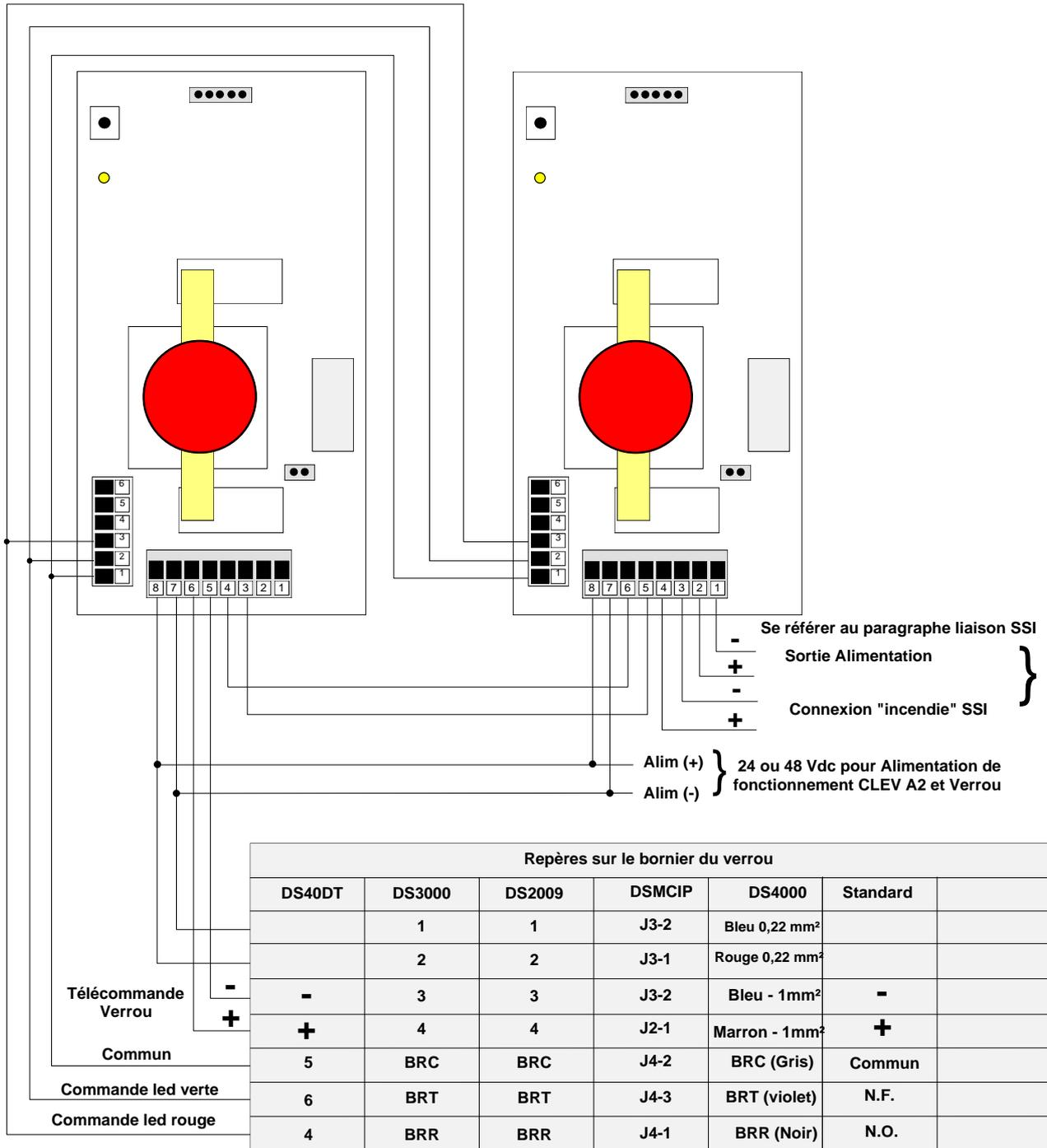
De manière générale, positionner une diode de protection sur l'entrée de la tension de télécommande du système de verrouillage hors gamme Alligator (gache, ventouse ...)
