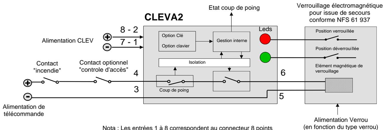
La partie télécommande est isolée galvaniquement de la partie de contrôle du CLEVA2.
