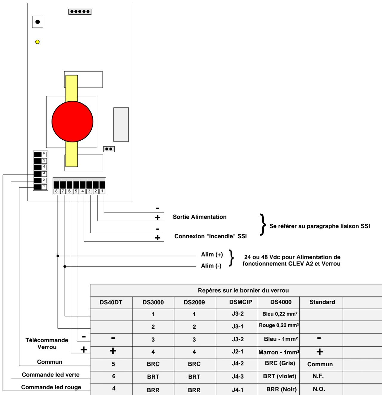
De manière générale, positionner une diode de protection sur l'entrée de la tension de télécommande du système de verrouillage hors gamme Alligator (gache, ventouse ...)
