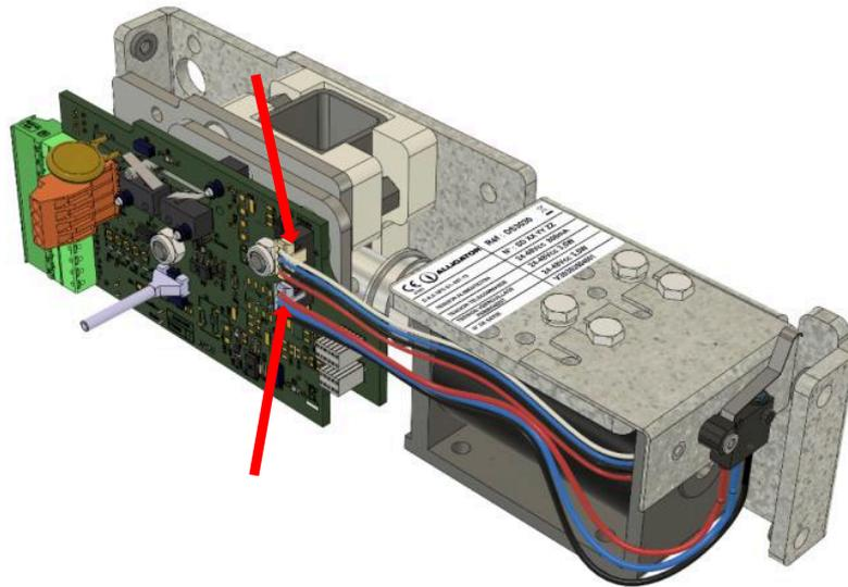
2. Déposer le contact effraction avec son support.
