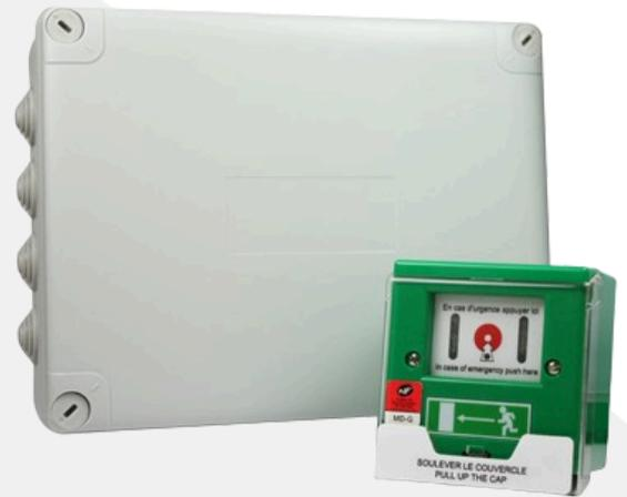
Le déverrouillage d'urgence de l'issue verrouillée électriquement est possible par une action locale sur le DDOD placé près de l'issue et entraînant le déverrouillage automatique après une temporisation de 8 secondes (T1). Une temporisation supplémentaire de 3 minutes (T2) peut-être obtenue à partir de l'UGCIS. Le déverrouillage s'effectue alors après une levée de doute visuelle de l'issue concernée.
