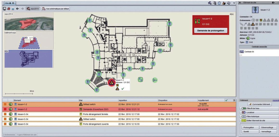
Issu d'une solide expérience en matière de gestion centralisée, Visualis 3D s'adapte aux différentes envergures de site et répond parfaitement aux besoins les plus larges des exploitants. Vous visualisez en temps réel et à distance l'état de l'ensemble des issues de secours et les points d'alarme exacts. Vous pouvez ainsi agir rapidement et efficacement.
